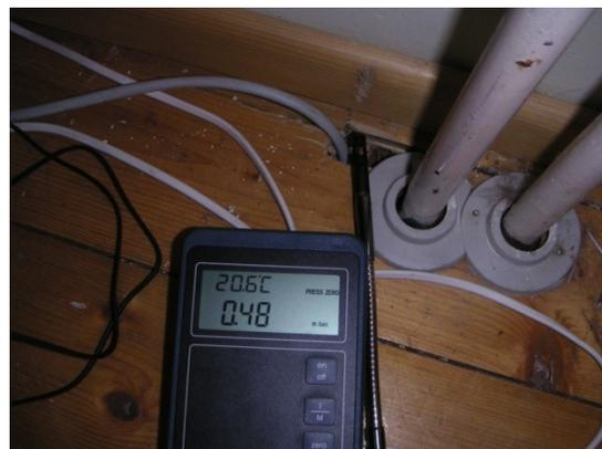
Abbildung 45: Leckageortung Fußbodenkonstruktion (vor Fenstertausch)
