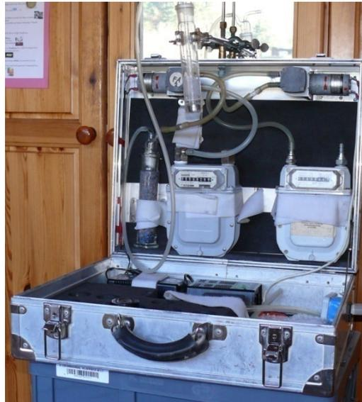
Abbildung 10: Probenahmeapparatur für Formaldehyd und VOC
