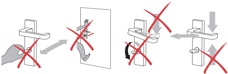
Drücker, Griff, Hebel, Schlüssel nur in die dafür vorgesehene Richtung bewegen. Bewegen entgegengesetzt der Betätigungsrichtung kann die Elemente zerstören oder beschädigen.
