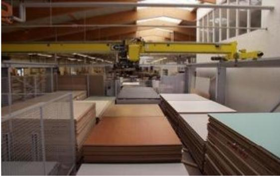
Abb. 1.1: Chaotisches Plattenlager mit CNC-gesteuertem Plattenkran
