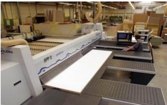
Abb. 1.3: Horizontale Plattenaufteilsäge
