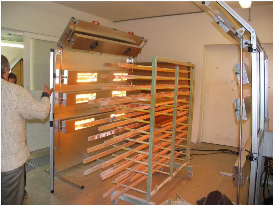
Abb. 2.5: Trocknungsanlage in Betrieb (30% Leistung)
