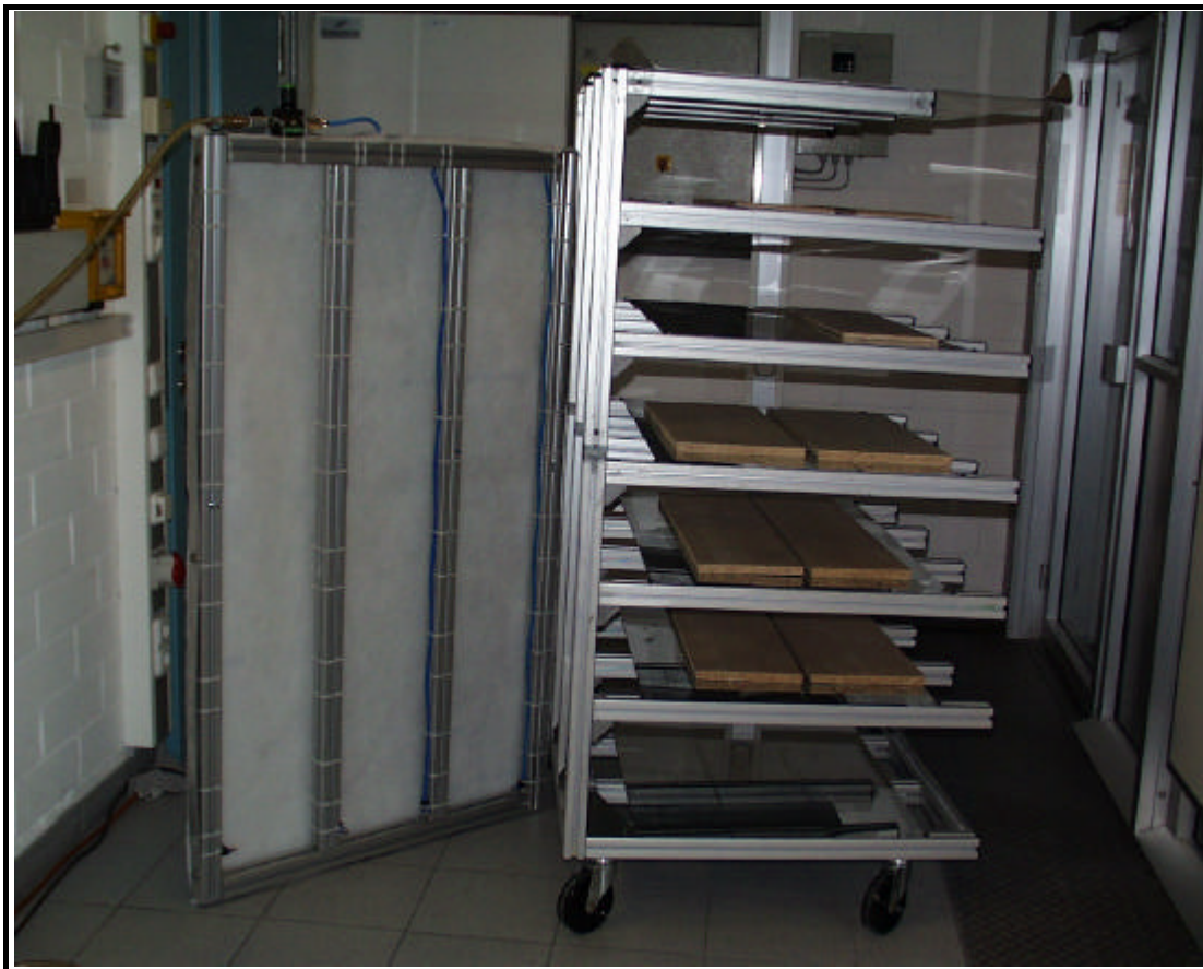
Abb.1: Prototyp der Hordenwagenbelüftung; Hordenwagen mit (aufgeklappter) Rückwand und daran befestigten Luftverteilungsschläuchen
