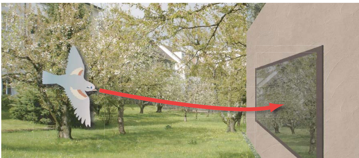
Sonnenschutzgläser und viele andere Glastypen haben einen hohen Reflexionsgrad. Je stärker sich die Umgebung spiegelt und je naturnaher diese ist, desto häufiger kommt es zu Kollisionen.
