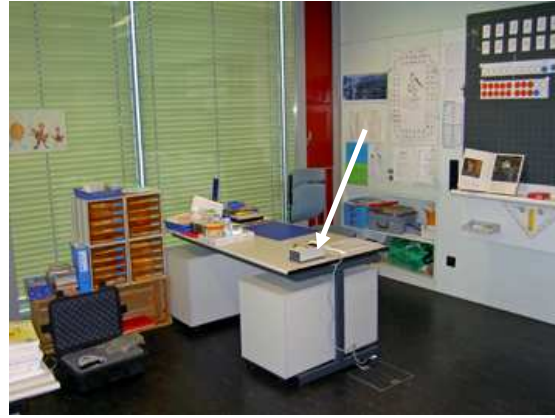
Abb. 10: CO 2 -Messung im Raum 27 (mech. Lüftung), Schulhaus Baden Dättwil
