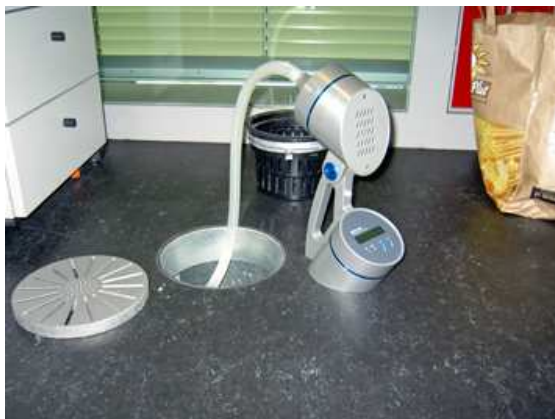
Abb. 13: Luftkeimmessung im Zuluftstrom, Schulhaus Baden Dättwil
