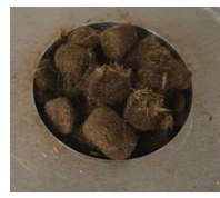
Bild 8: recycelte MDF-Fasern und neu hergestellten Holzwerkstoff
