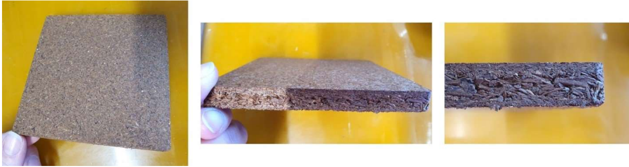
Bild 24: Bauteil aus recycelten Spanplattenspänen
