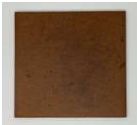
Bild 38: Aus Faserrezyklat hergestellte MDF-Platte
