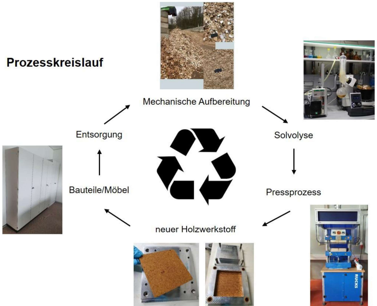
Bild 2: Angestrebter und umgesetzter Prozesskreislauf
