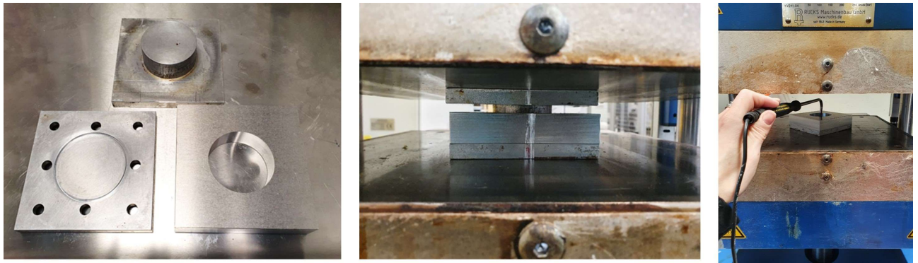
Bild 6: Puckwerkzeug mit Temperaturmessung und – aufzeichnung in der Heißpresse
