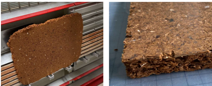
Bild 69: Eigenschaftsprüfung am Spanplattenbauteil ReSpan_184
