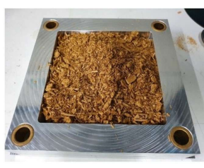
Bild 10: Quadratisches Tauchkantenwerkzeug (110 mm x 110 mm x 20 mm)
