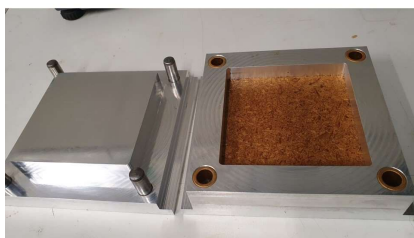
Bild 10: Quadratisches Tauchkantenwerkzeug (110 mm x 110 mm x 20 mm)
