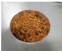
Bild 7: recycelten Palettenklotzspänen und neu hergestellten Holzwerkstoff
