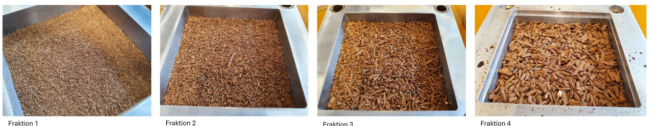
Bild 23: Schichten (fein bis grob) von einer neu hergestellten Spanplatte beim Befüllen des Tauchkantenwerkzeuges
