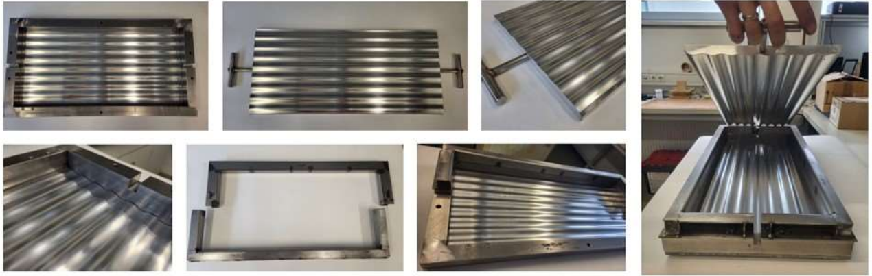
Bild 30: Aluminium-Presswerkzeug für horizontales Stopfverfahren
