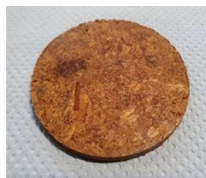
Bild 7: recycelten Palettenklotzspänen und neu hergestellten Holzwerkstoff
