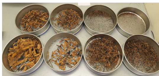
Bild 35: Fraktionierte OSB-Späne nach Solvolyse und Lösemittelabzug
