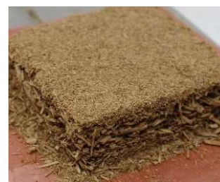
Bild 36: Gestreutes Spanvlies zurückgewonnener Späne mit definiertem Rohdichte-profil
