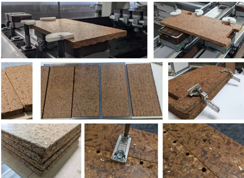
Bild 71: Fertigung Bauteile Demonstrator-Möbel und Einsatz Beschlagstechnik
