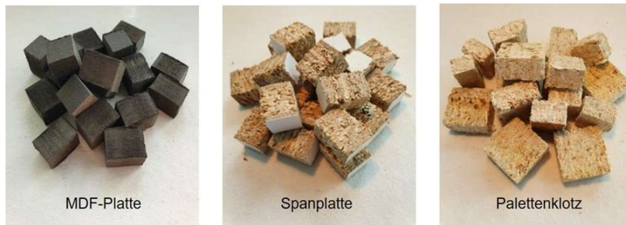
Bild 3: Ausgangsmaterial für die untersuchten Abbauprozesse
