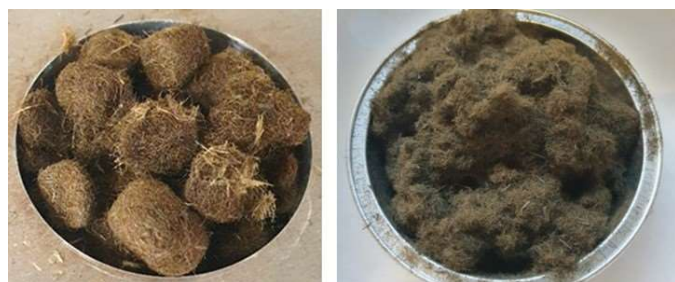
Bild 12: Recycelte MDF-Platten → Faseragglomerate (links) und Einzelfasern (rechts)
