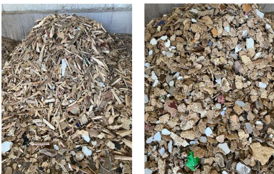
Bild 49: Sortierter Massivholzanteile (li) und Holzwerkstoffanteil (re)
