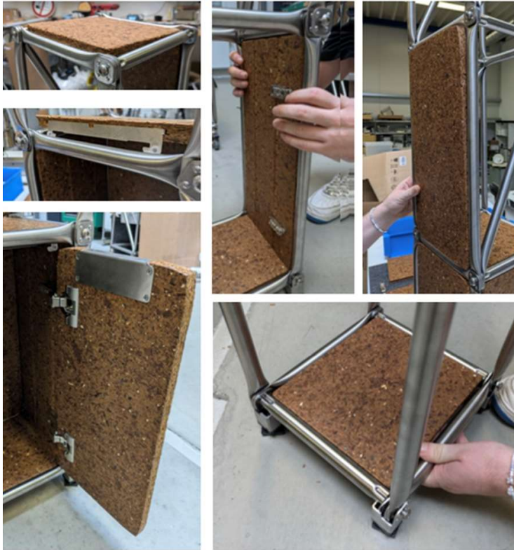
Bild 72: Einbau der Holzbauteile in Stahlstruktur Demonstrator-Möbel
