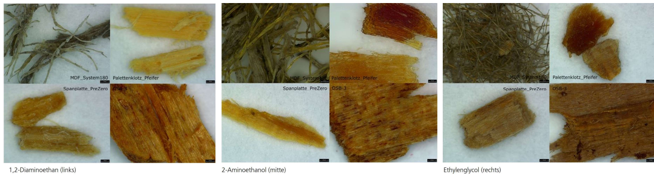
Bild 20: Mikroskopieaufnahmen nach Solvolysen mit den unterschiedlichen Reagenzien
