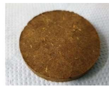
Bild 8: recycelte MDF-Fasern und neu hergestellten Holzwerkstoff
