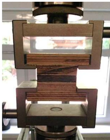
Bild 43: Prüfkörper zur Bestimmung der Querkzugfestigkeit in Anlehnung an DIN EN 319
