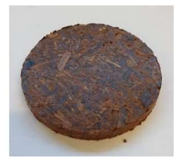
Bild 9: recycelte Späne sowie neu hergestellter Holzwerkstoff
