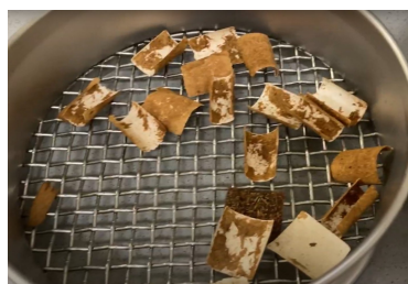
Bild 34: Abgetrennte Melaminharz-Beschichtung nach Solvolyse von Spanplattenproben
