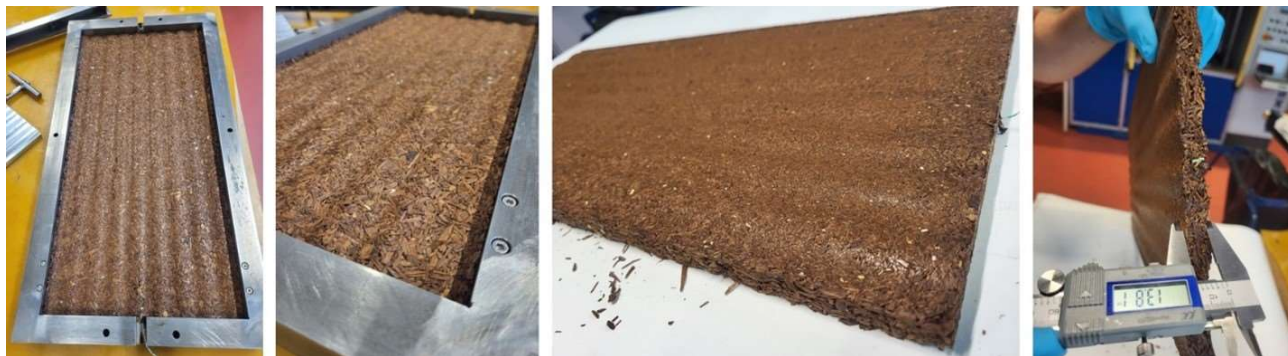
Bild 33: Entformung und Begutachtung des hergestellten Bauteiles
